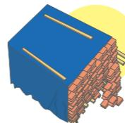
Lonas usadas para cobrir objetos ou entulho bem **esticadas** evitam a formação de poças d'água.
